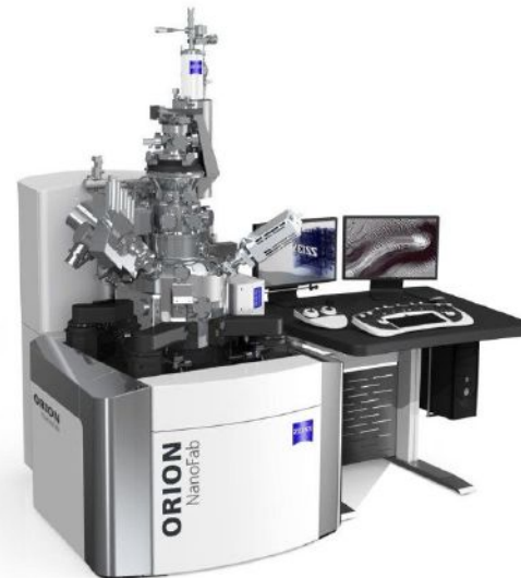
He-Ionenstrahl-Lithographie (Auflösung: ca. 5nm)
